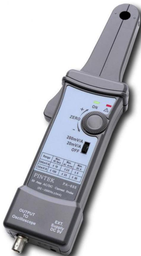
Токовый пробник для осциллографов. Максимальный ток DC  $\pm 50$  А; AC 100 Ап-п / 35 А скз. Частотный диапазон DC...500 кГц. 2 диапазона: 20 мВ/А, 200 мВ/А. Точность 3% (<5 А). Разрешение – 5 мА. Макс. рабочее/плав. напряжение 300V CAT III/600V CAT II. Питание – 9 В.
