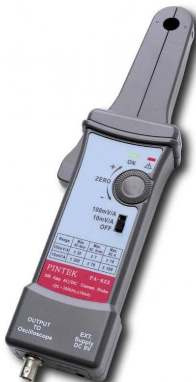
Токовый пробник для осциллографов. Максимальный ток DC  $\pm 100$  А; AC 200 Ап-п / 70 А скз. Частотный диапазон DC...300 кГц. 2 диапазона: 10 мВ/А, 100 мВ/А. Точность 3% (<10 А). Разрешение – 10 мА. Макс. рабочее/плав. напряжение: 300V CAT III/600V CAT II. Питание – 9 В.
